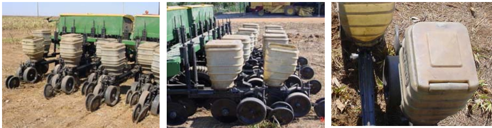
Figura 13 – Semeadora de soja adaptada para semeadura de algodão em linhas duplas 70cmx20cm. Lucas do Rio Verde– MT, 2005.
